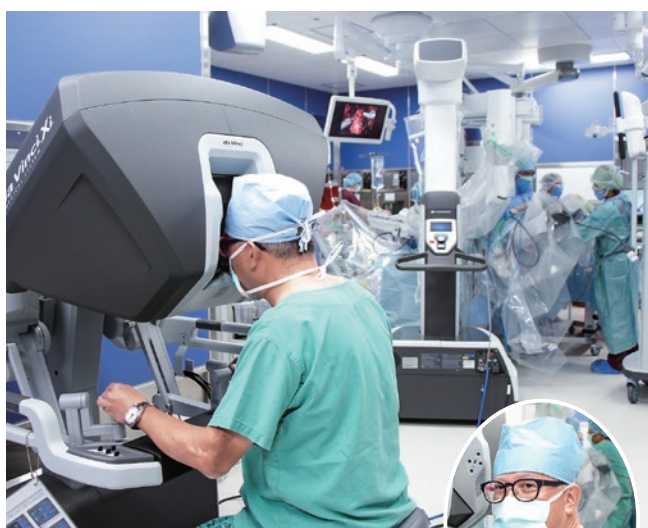
手術支援ロボット「ダヴィンチ」の指令装置で遠隔操作をする執刀医（野々村祝夫センター長＝円内も）。奥に見えるのがda Vinci（ダヴィンチ）Xi サージカルシステム
